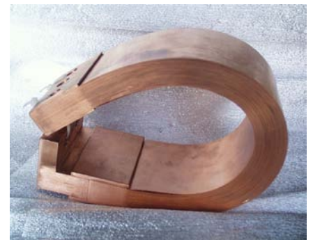
Kupfer Litze und Endstück elektronenstrahlverschweißt, um den Widerstand zu verbessern
