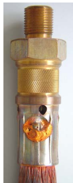
Kupfer Litze und Endstück elektronenstrahlverschweißt, um den Widerstand zu verbessern
